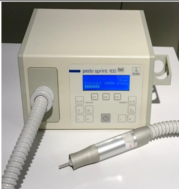
Fusspflegegerät Sprint 100 6000-40000U/min. Memoryfunktion, rechts/links-Lauf. Ein/Aus-Knopf am Handstück.
